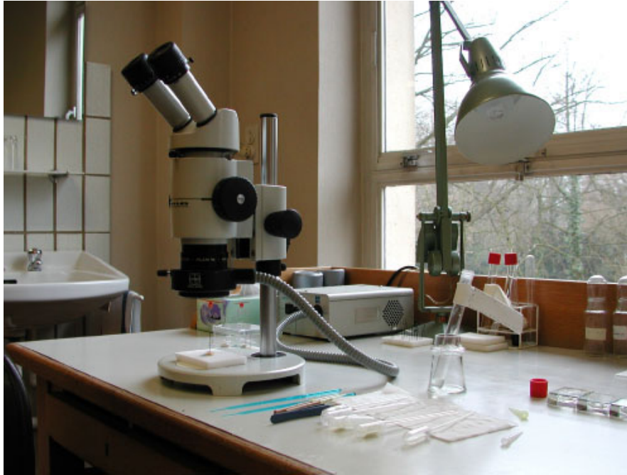
Figuur 1. Prepareermicroscoop met zoommogelijkheid (6× tot 50×).
